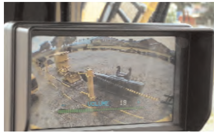
Abb. 6: Optimale Rücksicht durch Kamera-Monitorssystem
