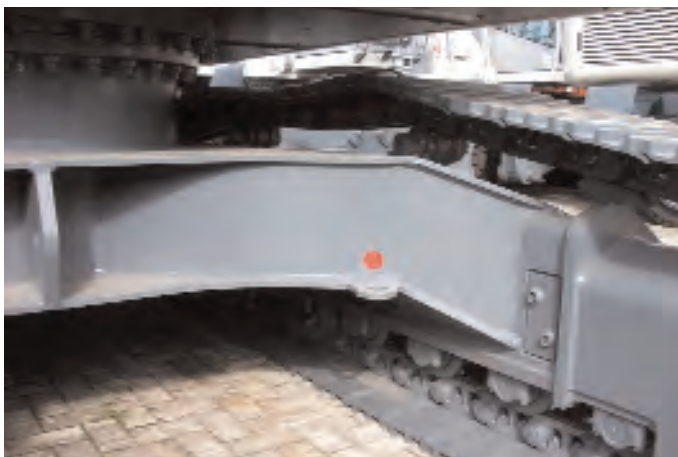
Abb. 9: Gut positionierter Zurrpunkt an neuem Kettenbagger
