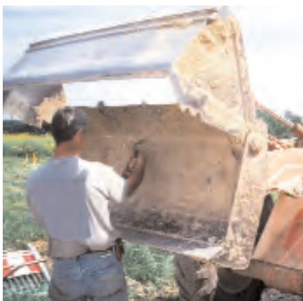
Abb. 14: Die Lage des Anbauhakens bedingt vorhersehbar ein gefährliches Anschlagen aus einer Position unterhalb des geöffneten Greifers
