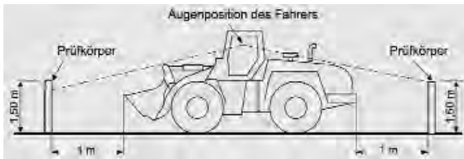
Abb. 2: Neue Nahbereichsmessung nach ISO 5006:2006 mit 1,5 m hohem Prüfkörper
