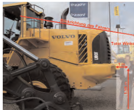
Abb. 4a, b: Direktsicht im Nahbereich unzureichend – Hersteller gleicht durch Kamera-Monitorssystem aus
