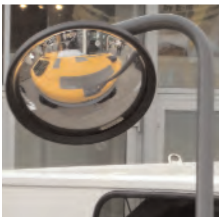
Abb. 8a: Spiegel zum Ausgleich von Sichtfeldeinschränkungen
