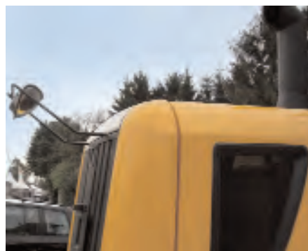
Abb. 8a: Spiegel zum Ausgleich von Sichtfeldeinschränkungen
