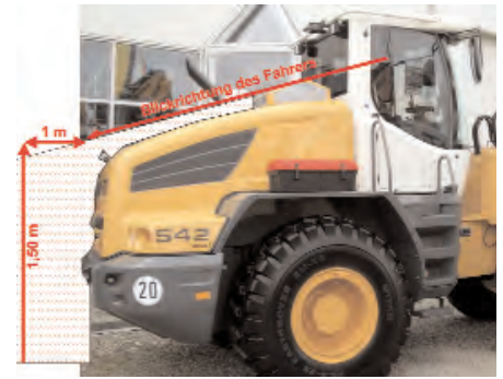
Abb. 7: Direktsicht nach Norm ausreichend – Freiwillig montierte Kamera verbessert das Handling des Radladers
