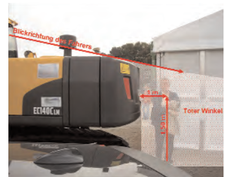
Abb. 4a, b: Direktsicht im Nahbereich unzureichend – Hersteller gleicht durch Kamera-Monitorssystem aus
