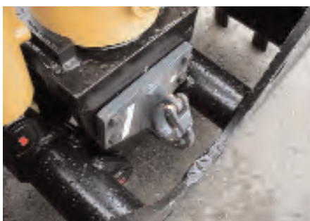
Abb. 14: Die Lage des Anbauhakens bedingt vorhersehbar ein gefährliches Anschlagen aus einer Position unterhalb des geöffneten Greifers
