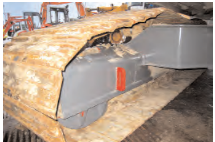
Abb. 10: Zurrpunkte fehlten – Bauunternehmer rüstet nach – Wer zahlt?
