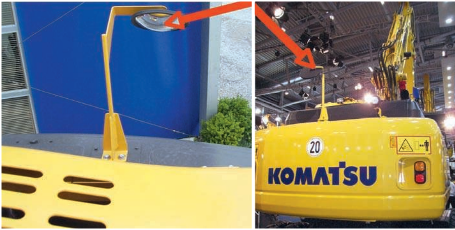
Abb. 6: Konvexer Spiegel am Heck eines Hydraulikbaggers
