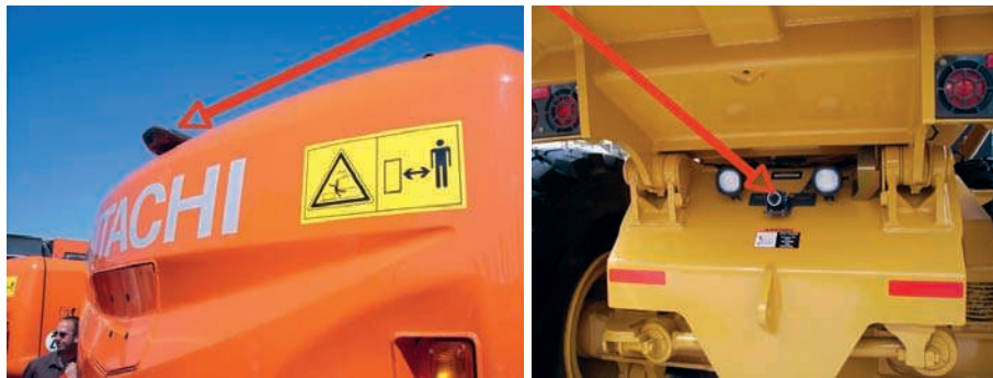
Abb. 7: Kamera am Heck eines Hydraulikbaggers und eines Dumpers
