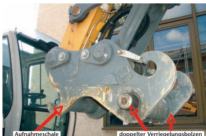
Abb. 1: Hydraulisch betätigte Schnellwechsel- einrichtung
